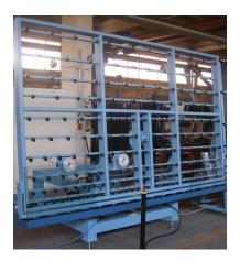
La table basculante hydraulique TVRB permet la translation de verre, double ou triple vitrage en position verticale et leur inclinaison de la position verticale à la position horizontale.
