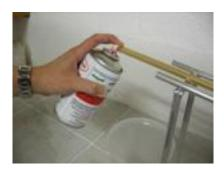
L'objectif de ce contrôle est de vérifier l'étanchéité de la fente soudée présente sur la partie postérieure d'intercalaires métalliques.
