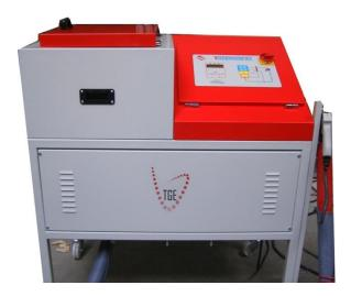
L'extrudeuse MK6B a été conçue pour l'application de colle hot melt de moyenne à haute viscosité. La machine permet le scellement du périmètre du vitrage isolant en simple et double barrière.
