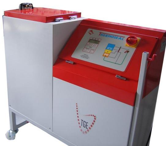
L'extrudeuse MK4B a été conçue pour l'application de colle hot melt de moyenne à haute viscosité. La machine permet le scellement du périmètre du vitrage isolant en simple et double barrière.
