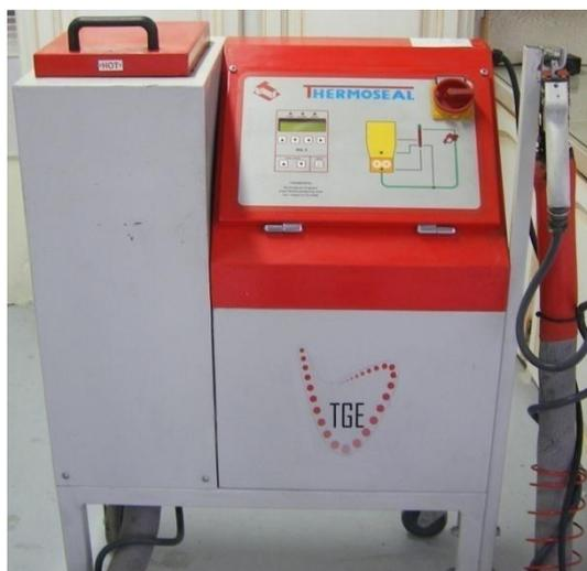
L'extrudeuse MK3 a été conçue pour l'application de colle hot melt de moyenne à haute viscosité. La machine permet le scellement du périmètre du vitrage isolant en simple et double barrière.
